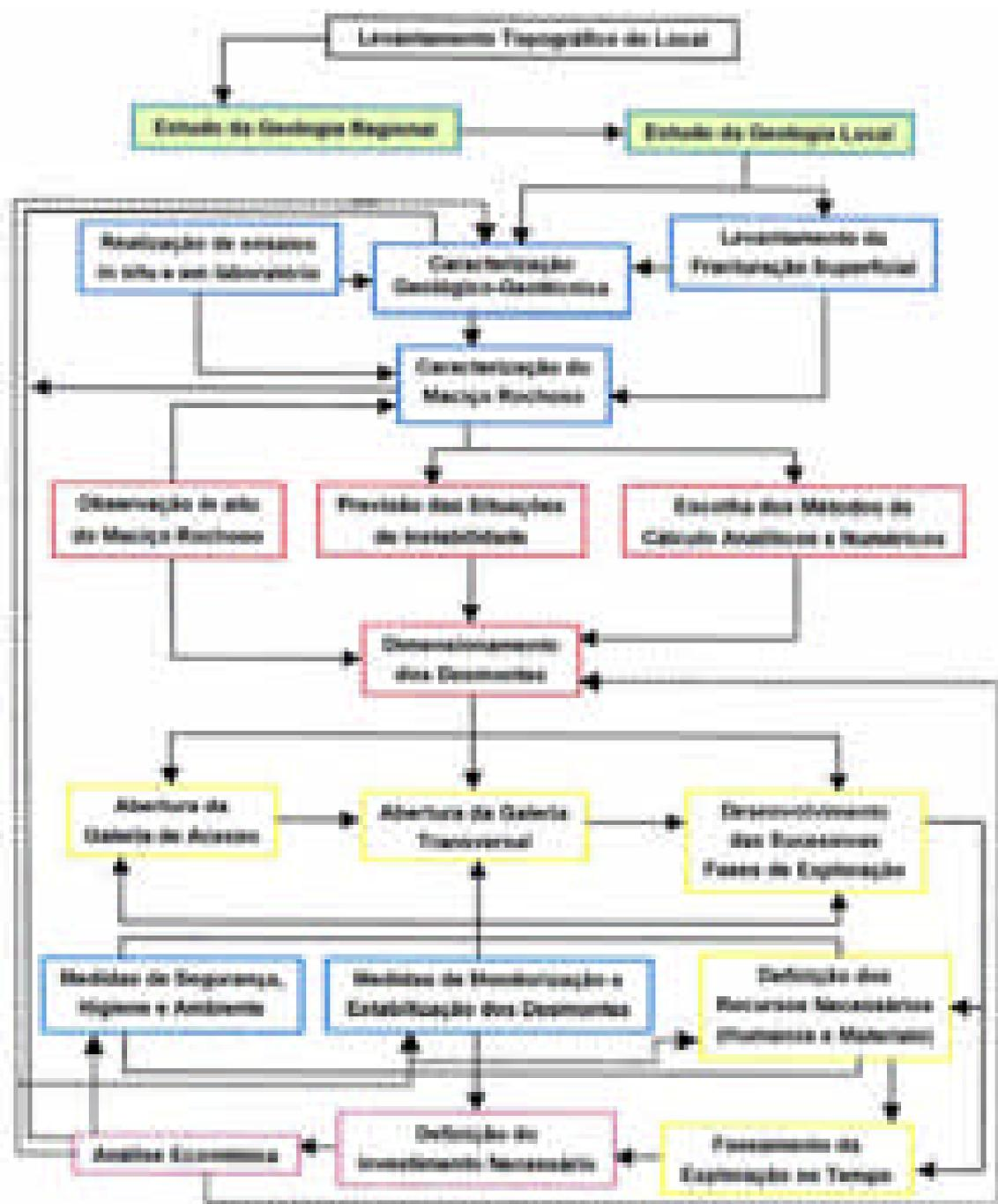
Fig. 5.2 – Principais fases de um projecto de exploração subterrânea de rochas ornamentais (extraído e adaptado de Gama *et al.*, (2000), após adaptação de Fornaro e Bosticco (1999).
