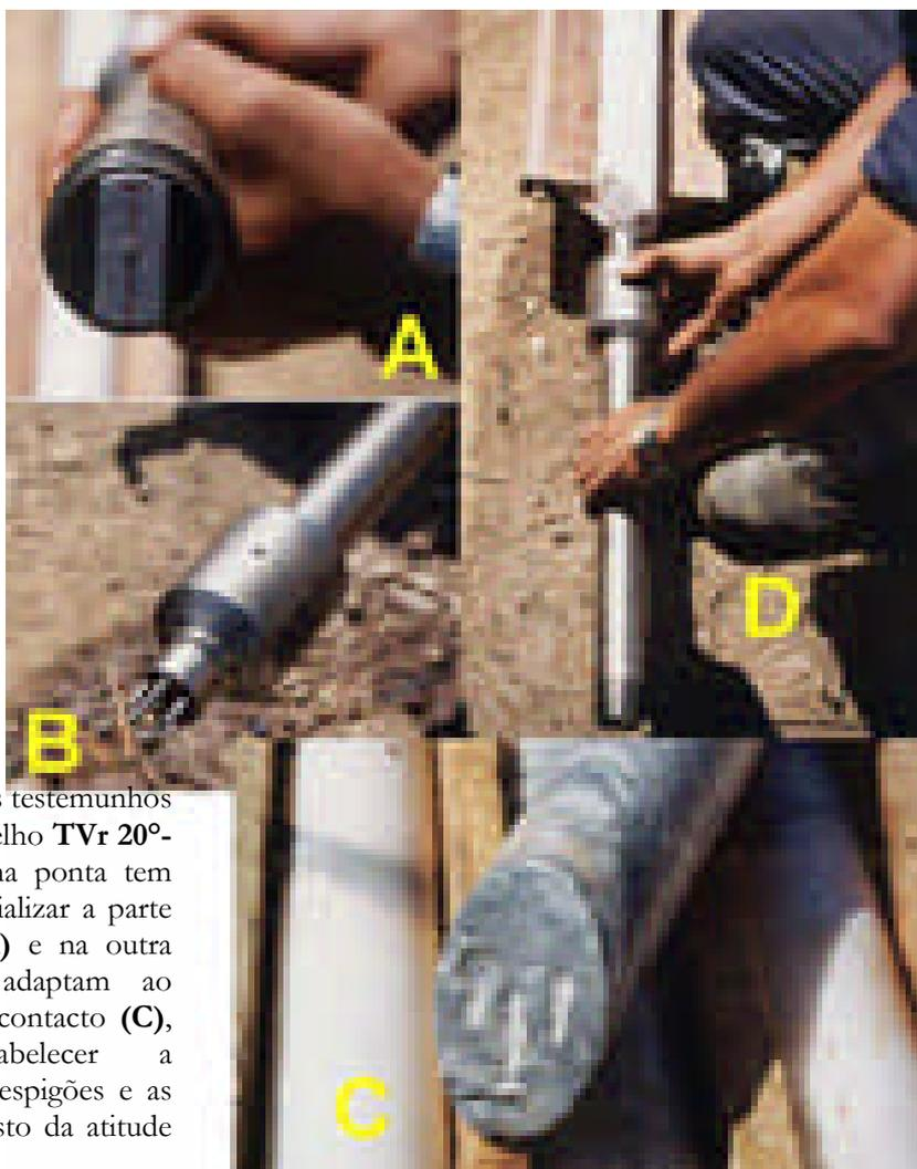
Fig. 5.11 – Orientação dos testemunhos das sondagens com o aparelho **TVr 20°-160°**. O instrumento numa ponta tem uma referência para materializar a parte superior da sondagem **(A)** e na outra espigões **(B)** que se adaptam ao encontrar a superfície de contacto **(C)**, depois e só estabelecer a correspondência entre os espigões e as marcas **(D)** e fazer o registo da atitude do plano.
